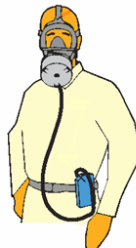
Mască completă cu sistem de ventilație
