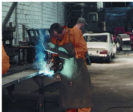
emisie de fum de la sudură.
