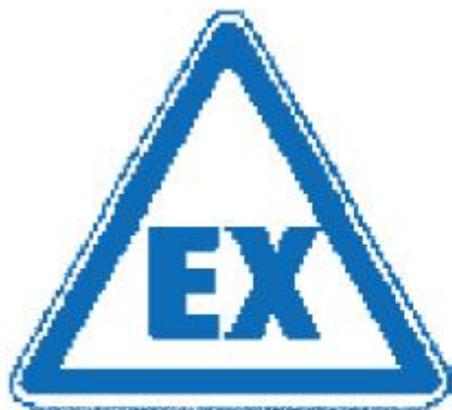
Figura 4.3: Indicator de avertizare pentru locuri unde pot apărea medii explozive.
