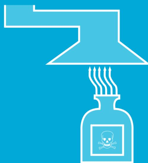
Utilizează aspirația locală pentru a suplimenta ventilația generală
