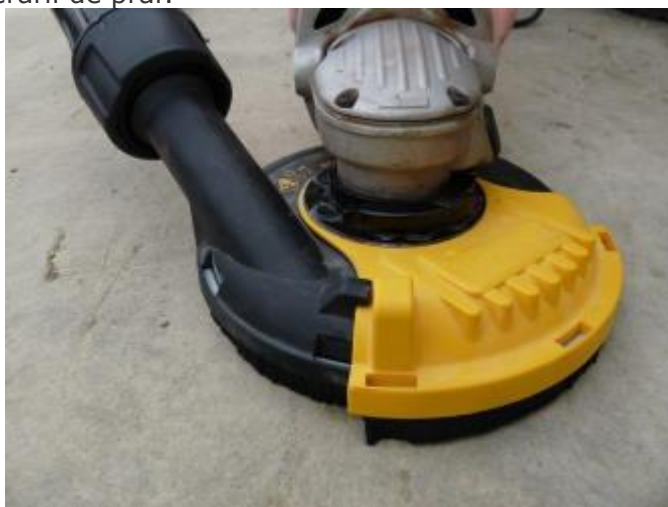
Figura 3 Polizor dotat cu echipament de îndepărtare a prafului (Sursa HSE, Regatul Unit)
